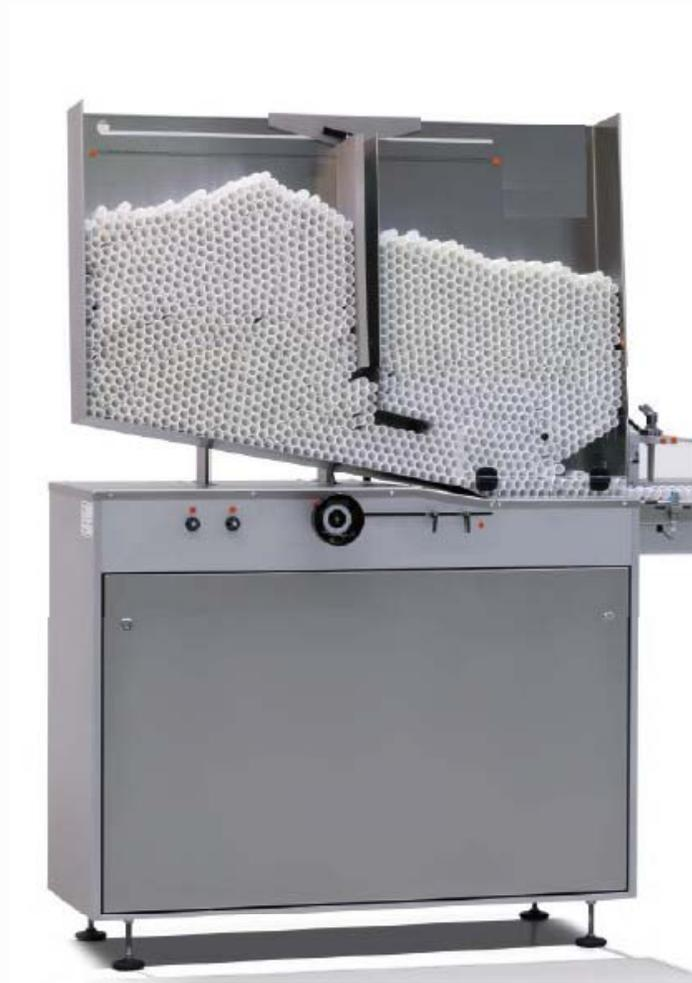
管仓容量大小根据对应设备速度进行设计，使一次放置可以使用6分钟以上，即WX机一次可倒入3盒管材；IWKA/C一次可倒入4盒管材；ND-S/Y一次可倒入5盒管材。
